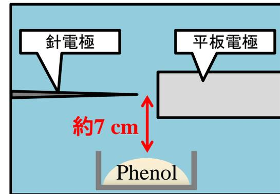
反応器内サンプル設置の模式図
