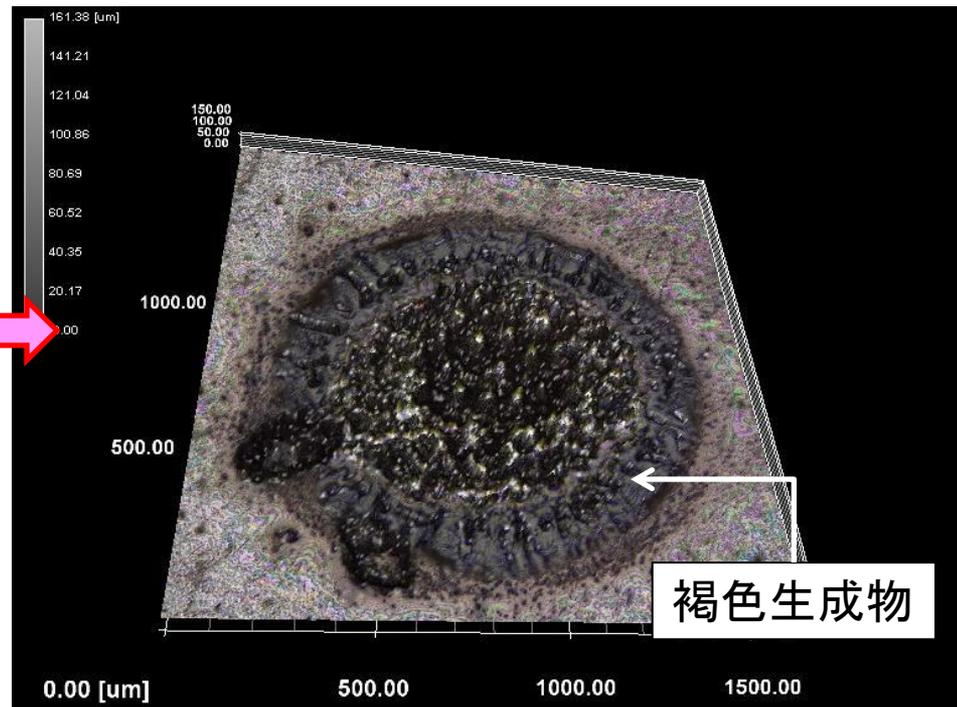
放電痕レーザー顕微鏡写真(20倍)
