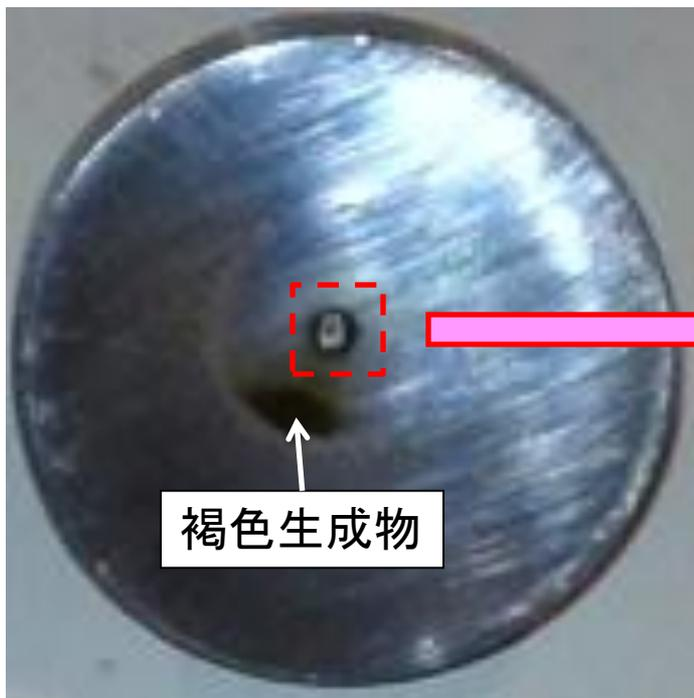
回収電極写真(100,000回放電時)
